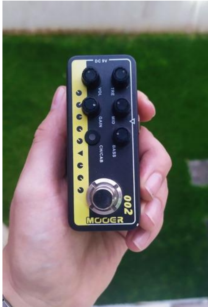
სურათი 9. იმავეს სიმულაცია ტრანზისტორულ სქემაზე დაფუძნებულ პედალში. რამდენჯერმე პატარა და იაფი, თუმცა ხმის ხარისხი საგრძნობლად ჩამოუვარდება
