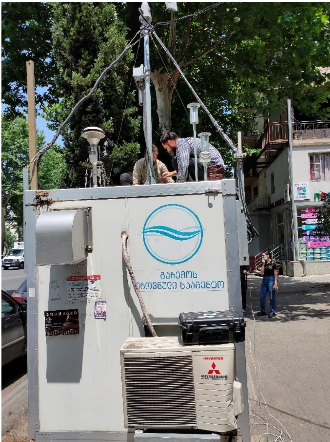
სურათი. 7 ჰაერის მონიტორინგის სადგურზე “SOWA” სენსორის დამონტაჟება
