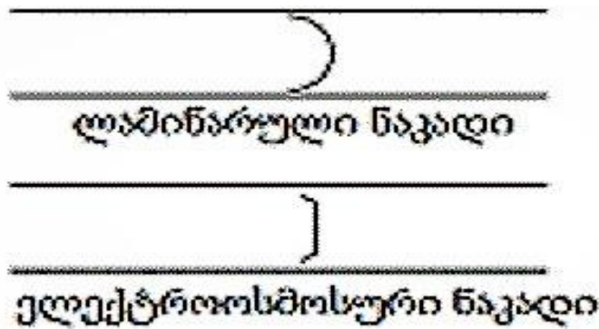
ნახ. 6 ელექტროოსმოსური ნაკადისა და ლამინარული ნაკადის შედარება
