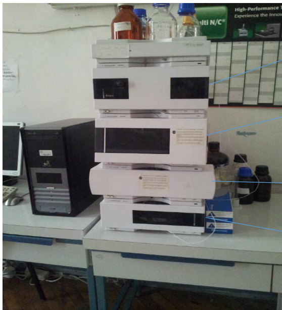
სურათი. 3 მაღალეფექტური სითხური ქრომატოგრაფი
