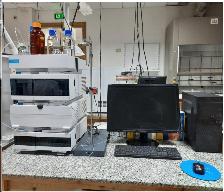
ნახ.8 Agilent Technologies წარმოების 1260 სერიის მაღალეფექტური სითხური ქრომატოგრაფი.
