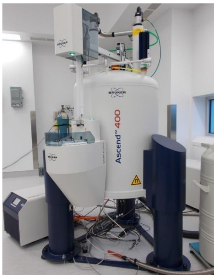
ნახ.13 ბირთვულ-მაგნიტური რეზონანსის სპექტროსკოპიის ხელსაწყო
