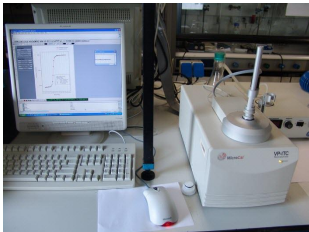
ნახ. 16. იზოთერმული მიკროკალორიმეტრის ხელსაწყო. VP-ITC Calorimeter.
